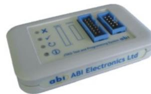
Контроллер JTAGMaster от компании «ABI» представляет собой универсальное высокоэффективное средство, предназначенное для выполнения проверок, обнаружения неисправностей и программирования сложных печатных плат в сборе. Работающий на основе гибкого программного обеспечения AIMs, контроллер JTAGMaster также интегрируется с используемыми настройками.
