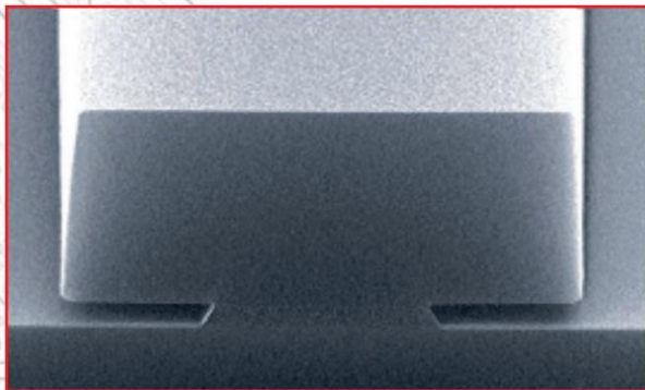
LOL 2000 на Si при 200 °C/5 мин. с 5,0 микронами SPR950
