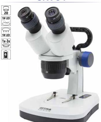
Бинокулярный стереомикроскоп оснащен поворотным объективом (1x-3x), неподвижной рукояткой с ручкой и невероятно ярким и равномерным светодиодным освещением (передаваемым и падающим), устанавливаемым через эксклюзивное сенсорное управление. Питание от аккумуляторных батарей.
