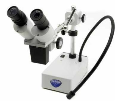
Бинокулярный стереомикроскоп оснащен неподвижным объективом (2x), поворотным светодиодом падающей подсветки на свисающем гибком рычаге. Идеально подходит для больших рабочих расстояний (110 мм со стандартным объективом 2x, 154 мм с ST-025, 111 мм с ST-026).
