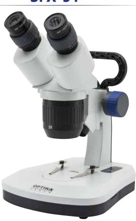
Бинокулярный стереомикроскоп оснащен поворотным объективом (2x-4x), вращающейся на 360 ° головкой, неподвижным рычагом с рукояткой и невероятно ярким и равномерным освещением (проходящим и падающим), настраиваемым с помощью эксклюзивного сенсорного управления. Работает на аккумуляторных батареях.
