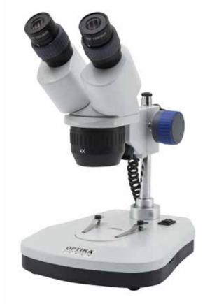
Бинокулярный стереомикроскоп оснащен поворотным объективом (2x-4x), штативом-стойкой и невероятно яркой и равномерной светодиодной подсветкой (проходящей и падающей) с аккумуляторными батареями.
