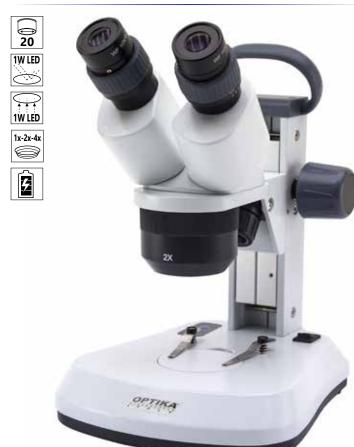
Бинокулярный стереомикроскоп оснащен поворотным объективом с 3-мя увеличениями (1x-2x-4x), прецизионной фиксированной ручкой с ручкой, а также невероятно яркой и равномерной светодиодной подсветкой (передаваемой и падающей), настраиваемой с помощью эксклюзивного сенсорного управления. Питание от перезаряжаемых батарей.
