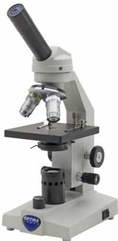
**Классический монокулярный микроскоп, оснащенный эффективной светодиодной подсветкой и внутренними аккумуляторными батареями, обеспечивает до 8 часов работы на открытом воздухе.**
