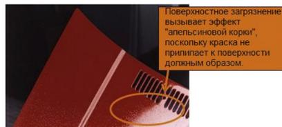
Рис. 1. Дефект, вызванный поверхностным загрязнением
